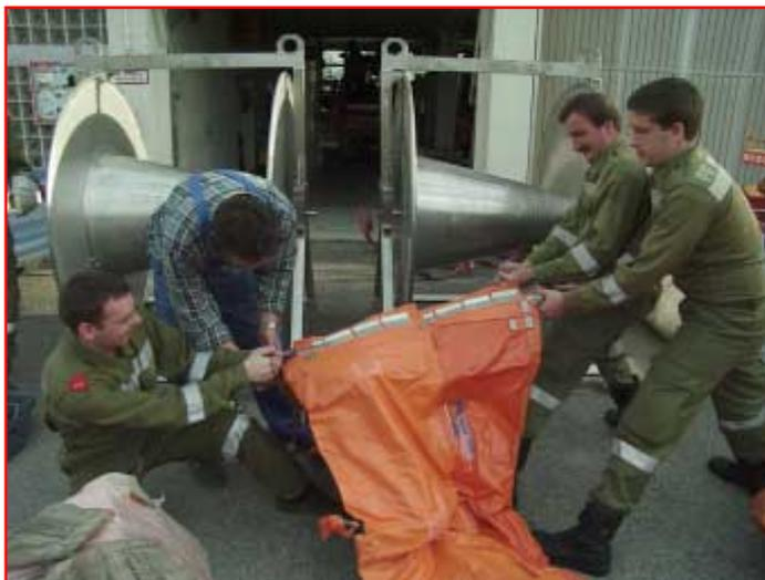
Aufbau und Fertigstellung der neuen Trommeln für jeweils 75 Meter Ölsperren, die am Kranfahrzeug mitgeführt werden.
