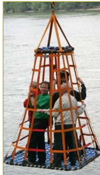
Mehrere Feuerwehren – darunter auch die FF Alkoven – waren am 6. Mai 2006 bei einem angenommenen Schiffsbrand auf der Donau im Einsatz. Hervorragend bewährt hat sich dabei das in Verbindung mit dem Kranfahrzeug eingesetzte Personennetz. Damit konnten die vom Schiff in die Arbeitsboote evakuierten Personen rasch und sicher über die steile Uferböschung gehievt werden. Fotos: Kollinger
