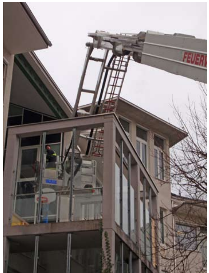
Stellprobe mit der TMB auch im Institut Hartheim. Einige Aufstellflächen müssen verbessert werden. Keine Schickane seitens der Feuerwehr, sondern lediglich ein Hinweis, um im Fall des Falles das Hubrettungsgerät auch aufstellen zu können.
