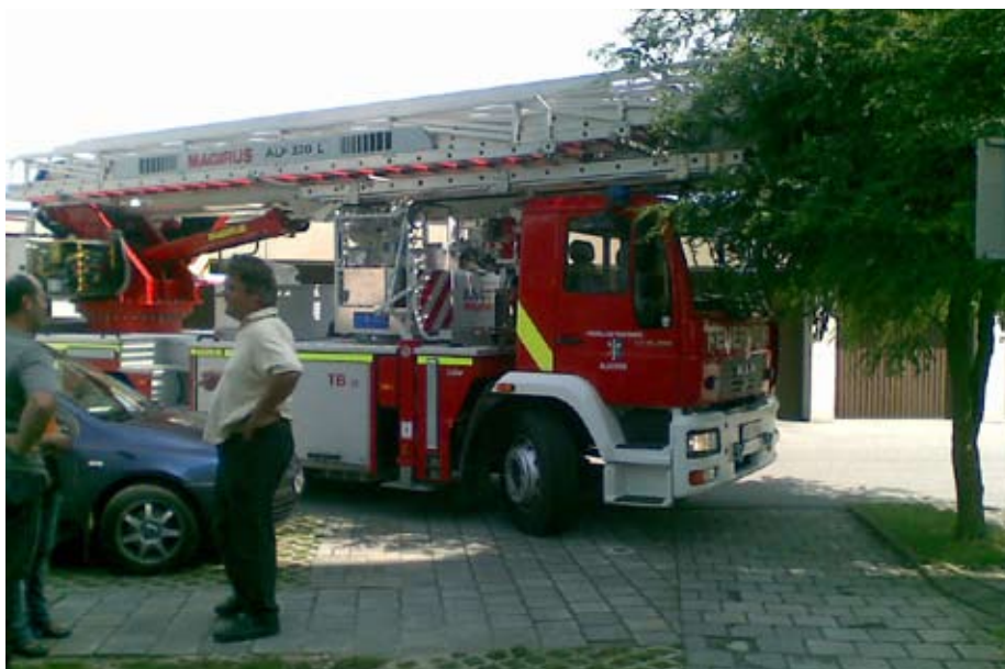
Unangekündigte Stellprobe bzw. Lokalausweis mit der Teleskopmastbühne in der Neubaustraße. Eine Zufahrt auf die vorgesehenen Stellflächen war unmöglich. Die Feuerwehr wies lediglich darauf hin, ob bauliche Maßnahmen ergriffen werden oder nicht obliegt dann nicht im Wirken der Feuerwehr. Fotos: Markus Unter
