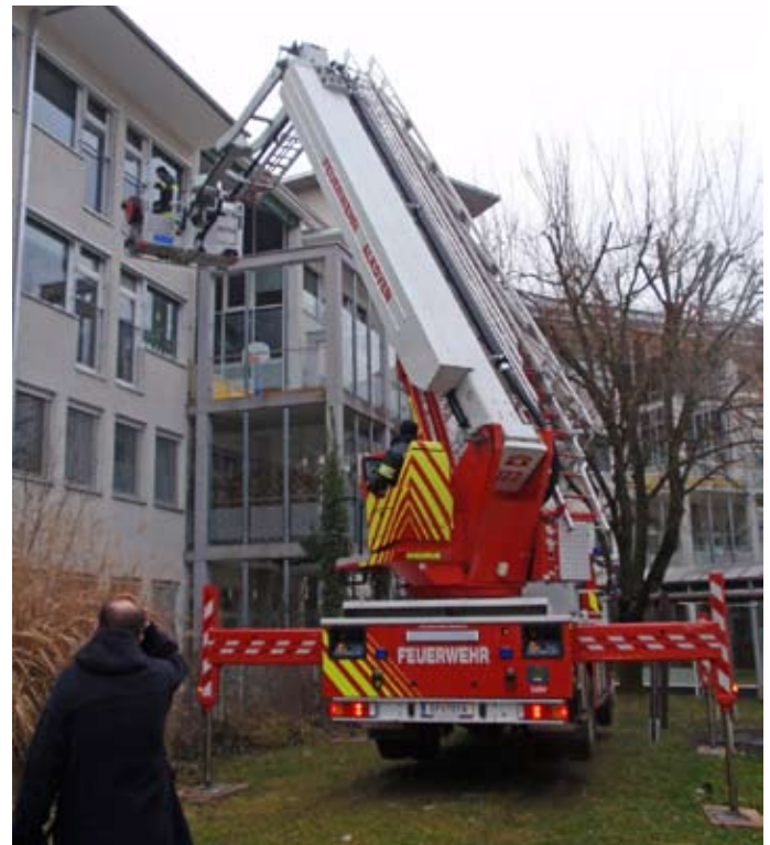
Stellprobe mit der TMB auch im Institut Hartheim. Einige Aufstellflächen müssen verbessert werden. Keine Schickane seitens der Feuerwehr, sondern lediglich ein Hinweis, um im Fall des Falles das Hubrettungsgerät auch aufstellen zu können.
