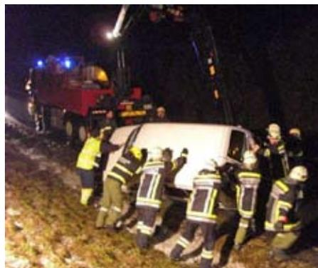
Fahrzeug zu bergen galt. Ein Pkw lag seitlich in einem Graben. Ein Aufrichten per Muskelkraft wäre nicht möglich gewesen. So wurden an der Oberkante zwei Gurte angebracht und der Pkw mit einer Drehbewegung des Krans aufgerichtet. Eine halbe Stunde nach dem Alarm waren die Helfer auch schon wieder zuhause. Einsatzzeit: 18.19 Uhr bis 19.07 Uhr. F: FF Schönering
