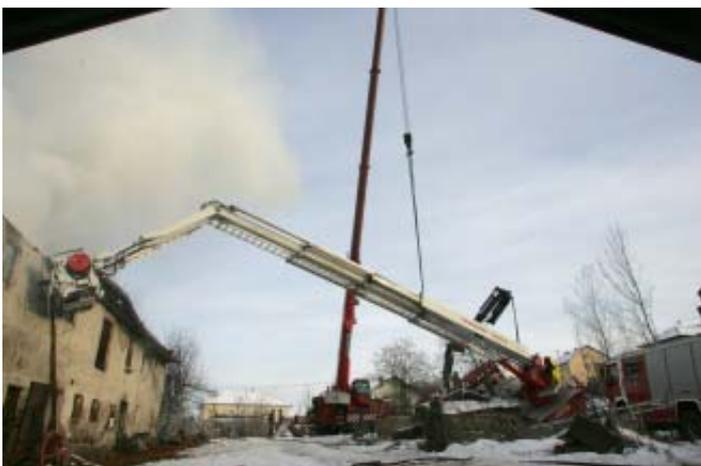
klemmt hatte. Um einer Beschädigung des Mastes entgegen zu wirken bzw. diesen nicht unnötig zu belasten wurde die eingebrochene Stütze mit Hebekissen und Unterlegmaterial in Millimeterarbeit immer wieder angehoben, bis das gesamte Fahrzeug wieder in der Waagrechten zum Stehen kam. Über den Elektro-Notbetrieb wurde das Gerät am Abend zusammengelegt und in einer
