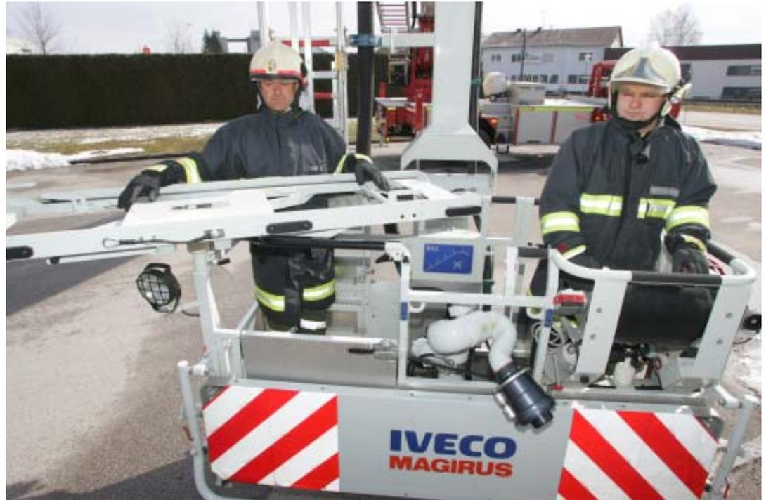
Mit der neuen Hubrettungsfahrzeuggeneration steht nun auch der FF Alkoven eine entsprechende Möglichkeit für den Transport einer Krankentrage zur Verfügung.
