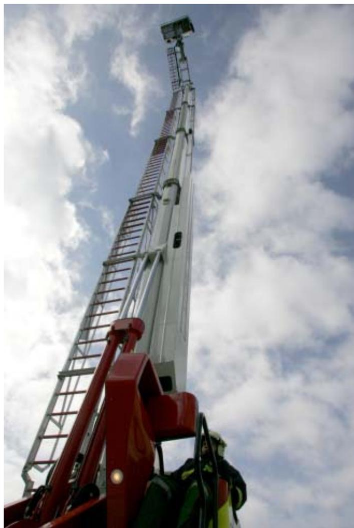
Die TMB weist eine Arbeitshöhe von 32 Metern sowie eine Rettungshöhe von 30 Metern auf.
