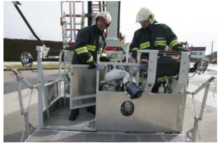
Nach dem Entfernen weniger Teile ist der Rettungskorb für das Einstellen eines Rollstuhls sowie dessen Benutzer bereit.
