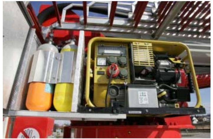
Die Atemluftflaschen dienen zur langfristigen Versorgung der im Korb stehenden Mannschaft bei längeren Einsätzen, beispielsweise bei der Brandbekämpfung von oben. Das Notstromaggregat kann sowohl vom Hauptbedienstand als auch vom Maschinisten im Korb gestartet werden.
