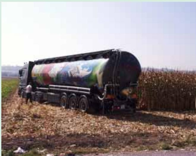
gliedern unterstützt. Nachdem der Versuch, den Lkw im direkten Zug aus dem Feld zu ziehen misslang, konnte der 40 Tonnen schwere Sattelzug erst nach Verwendung einer Umlenkrolle geborgen und wieder auf festen Untergrund gestellt werden.
