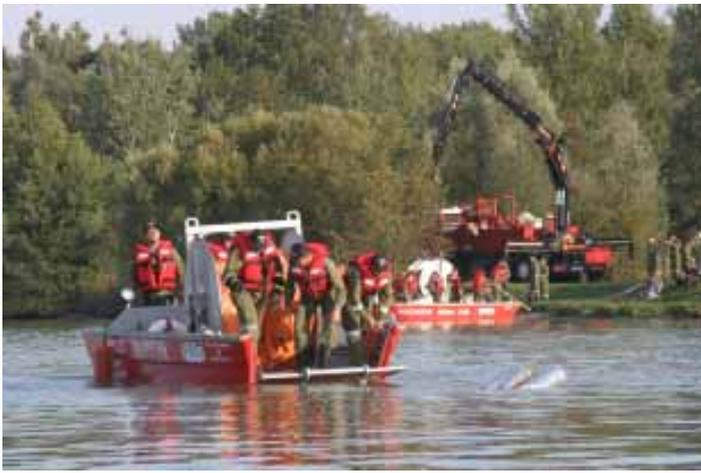
Mit den auf Rollen gelagerten Ölsperren sank das Arbeitspensum zum Aufbau einer Ölsperre enorm und das Zusammenstecken von je 3 Rollen á 25 Meter entfällt. Die Sperre wird vom A-Boot aus abgerollt.
