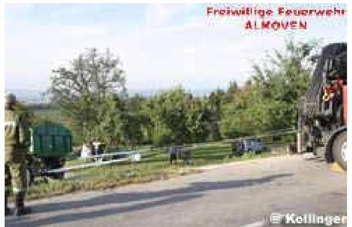
fährt selbst zu lösen. Anschließend wurde der Anhänger mit der Seilwinde des Kranfahrzeuges unter Verwendung von zwei Umlenkrollen (schließlich kam eine Zugkraft von über 20 Tonnen zusammen) vom Traktor entfernt und zur Reparatur bzw. zum Umladen des Ladegutes in die Wiese gestellt.
